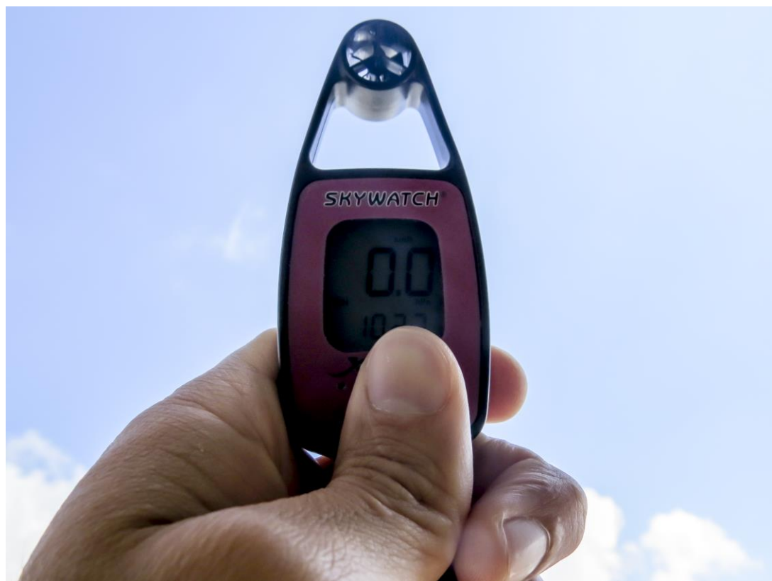
Anemometro portatile con sensori meteo, un utile strumento da campo (foto di Davide Valenti).
